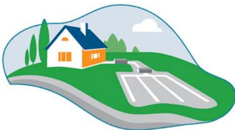
1 - Sumidouro/Vala de Infiltração
