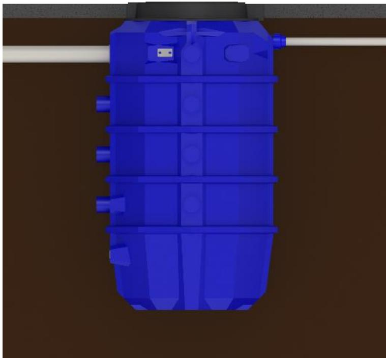
Nas configurações em que a elevatória se encontra abaixo do nível do piso, a profundidade do tubo de chegada (cota de chegada) possui uma profundidade padronizada de 270 mm, 650mm, 950mm e 1250mm na última opção. Essa distância é medida da linha inferior do tubo até o nível do piso. Para profundidades de chegadas maiores a Aquastar deve ser consultada.
